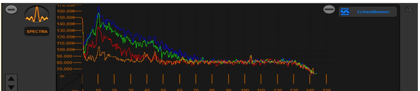
*Acouplet Spectra avec le spectre en temps réel en orange et trois visualisations de spectres sauvegardés (rouge, bleu et vert)*
