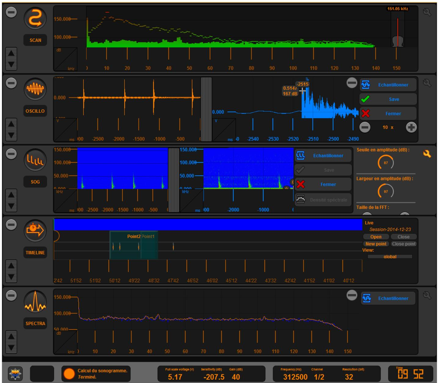
L'écran principal est composé d'une barre de contrôle (en bas) et plusieurs modules appelés *acouplets* (au dessus), organisés en racks, chacun avec une fonctionnalité spécifique pour l'écoute et l'analyse des ultrasons.
